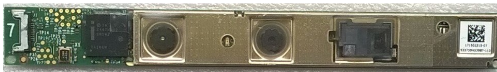
شكل ٩: اللوحة الإلكترونية لكاميرة الحاسوب المحمول (خارج الحاسوب)
