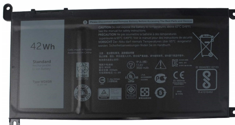
شكل ١٠: البطارية الداخلية لحاسوب محمول بسعة ٤٢ واط\ساعة
