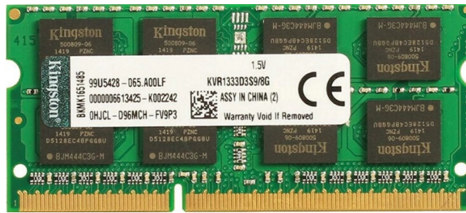
شكل ٥: ذاكرة حاسب محمول (Laptop) بحجم ٨ كيبا بايت ومن نوع DDR3
